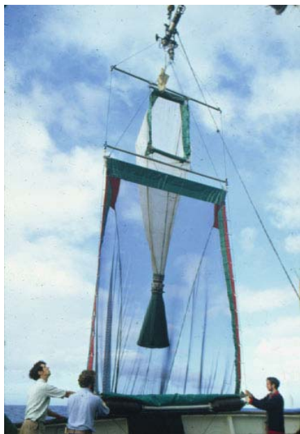
Figur 2. En öppnings- och slutbar rektangulär häv för provtagning uppe i vattenmassan (RMT1+8: Rectangular Midwater Trawl). Det undre nätet har en mynningsarea på 8 m 2 och en maskstorlek på 4,5 mm medan det övre har en area på 1 m 2 och maskstorlek på 0,33 mm. Denna kombination tillåter fler djur av olika storlekar att insamlas än om man hade bara ett nät. Näten öppnas och sluts samtidigt med hjälp av en akustisk signal från fartyget. (Foto: Southampton Oceanography Centre)
