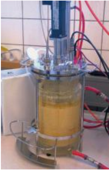
Figur 2. Experiment som visar etanol fermentering från torrmald majs. Massan är mycket viskös med en del grova partiklar suspenderade i den. [4]
