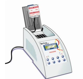
C Mångfaldiga den variabla regionen av kloroplast-DNA med hjälp av PCR - använd en PCR-apparat med tre olika temperaturer inställda eller tre vattenbad
