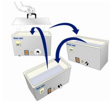
C Mångfaldiga den variabla regionen av kloroplast-DNA med hjälp av PCR - använd en PCR-apparat med tre olika temperaturer inställda eller tre vattenbad
