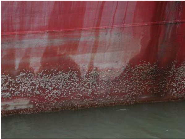
Figur 8. Ett båtskrov med havstulpaner som har limmat sig fast. När båten ser ut så här, går den alltför sakt och förbrukar alltför mycket bränsle. Det medför att båten är både oekonomisk och miljöstörande. (Med tillstånd från Johnny Eliasson, Stolt-Nielsen, NL)
